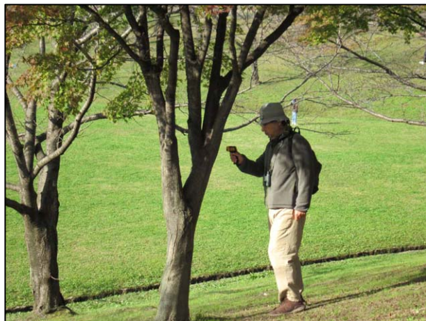
↑カエデの幹の表面温度 計測中↑
